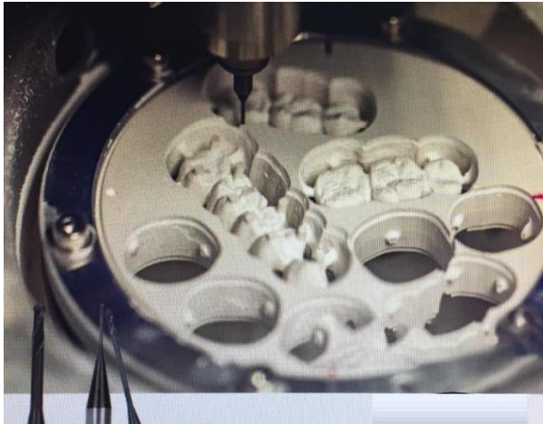
Рисунок 1. Применение мелкоразмерных фасонных инструментов.
