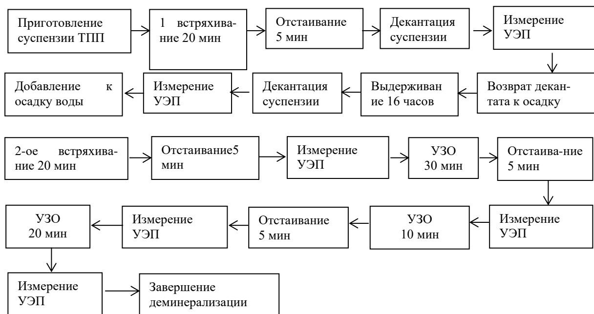
Рисунок 1. Стадии деминерализации твердых продуктов пиролиза углеродсодержащих отходов
