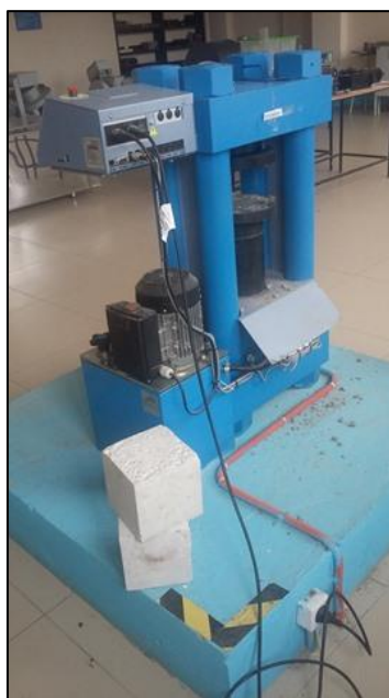
Рисунок 1. Испытания бетонных блоков под прессом
