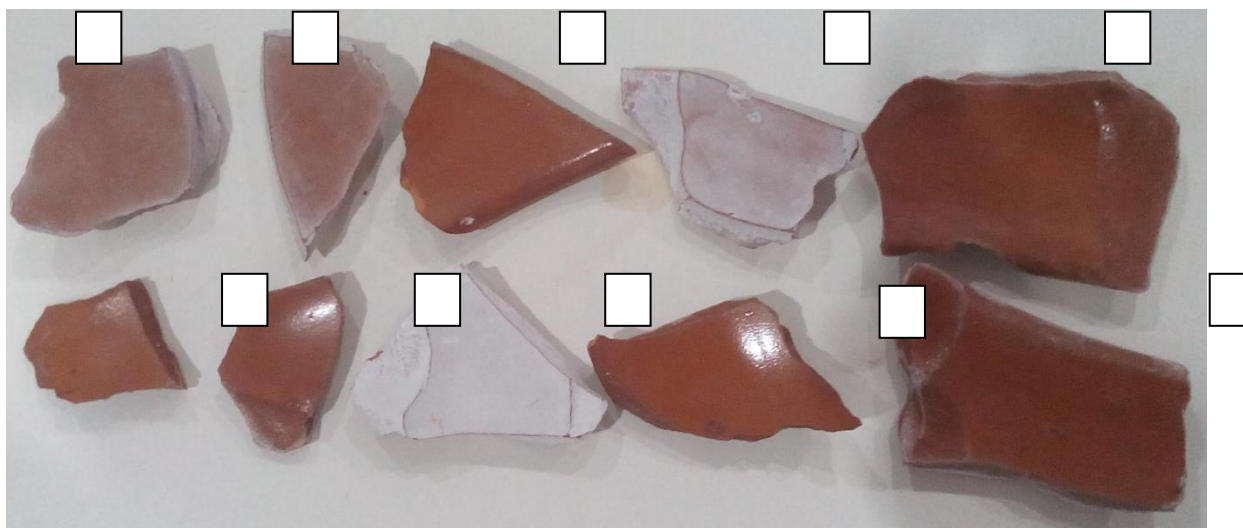
Рисунок 4. Внешний вид покрытий из нефритованных глазурей, приготовленных в 2 стадии: а – 1 состав, б – 2 состав, в – 3 состав, г – 4 состав, д – 5 состав, е – 6 состав, ж – 7 состав, з – 8 состав, и – 9 состав, к – 10 состав
