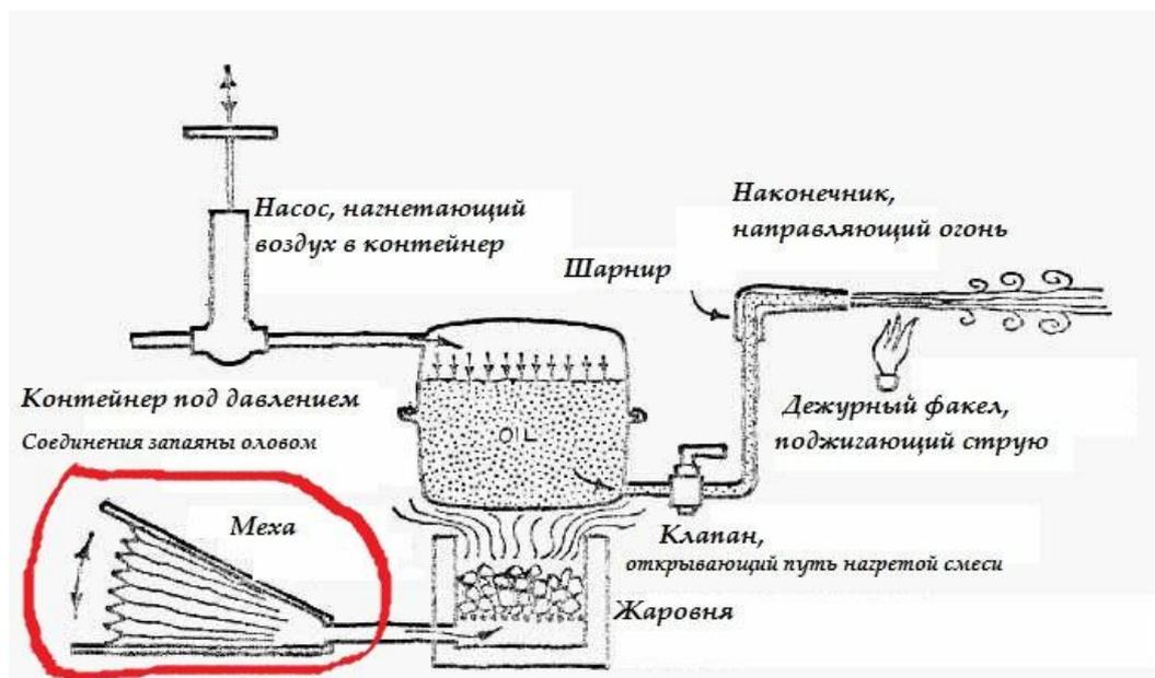
Рис. 8. Примерное устройство сифонофорной пушки 39
