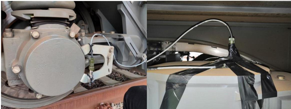
Рисунок 6 - Установка пьезоакселерометра на буксовом узле (слева) и над пружиной (справа)
