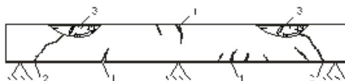
Рисунок 3 – Характерные трещины в изгибаемых железобетонных элементах:
