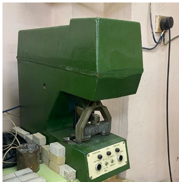
Рис. 1. Определение прочности на растяжение при изгибе.
