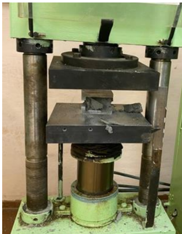
Рис. 2. Определение прочности при сжатии.
