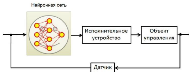
Рис. 1. Схема работы системы управления гидропоникой с использованием нейронной сети (НС)
