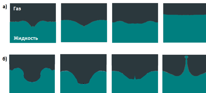
Рис. 2. Визуализация распада цифровой скоростной видеосъемки динамики удара капли о поверхность жидкости; а) отсутствие выброса вторичной капли, б) образование струи Рейля с последующим распадом и отделением вторичной капли в газовую среду.
